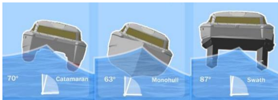
Figura 29 - Comparação do comportamento de embarcações na presença de ondas. Fonte: Melo, 2015
