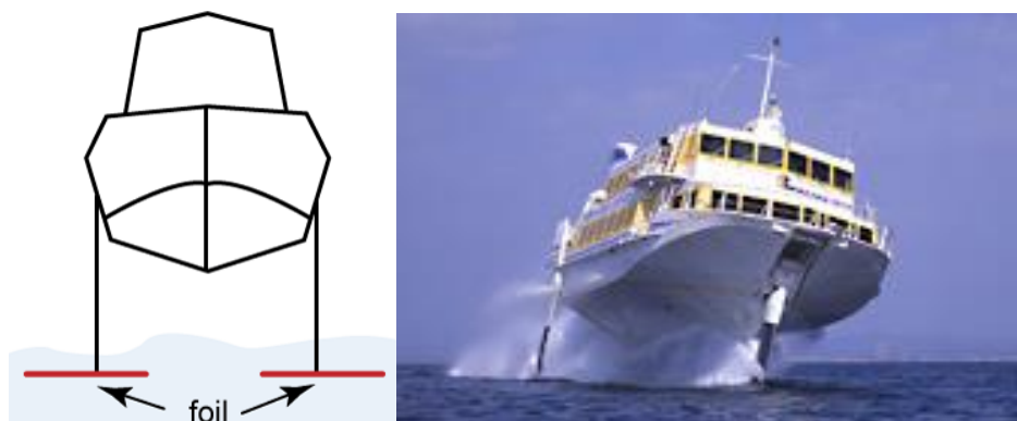
Figura 25- Aerobarcos com fólio submerso. Fonte: sado-biyori.com
